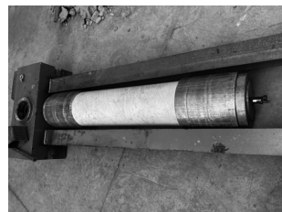
图10 柔性管安装固定
